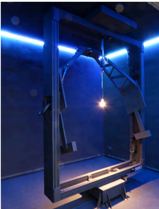
Goniophotometer der HED zur Messung von Lichtverteilungskurven
