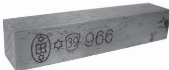
Härteprüfstab von 1939 - Länge 72 mm
