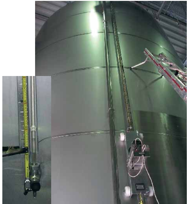
Lagerbehälter für Wein mit Skale und Standrohr
